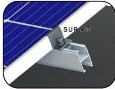
Fixar os Módulos Solar, nos perfis de apoio fixados anteriormente, utilizando o SUP 935 (presilha lateral) e SUP 937 (presilha intermediária), com auxílio de uma chave allen 6mm. Conforme figura abaixo:
