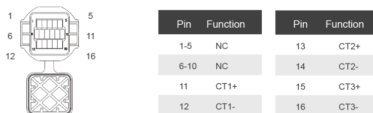
Figura 18 – Configuração do terminal do medidor
