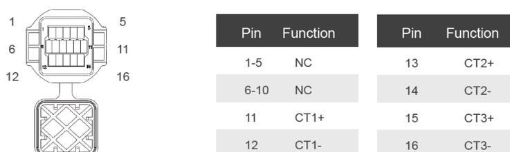
Figura 18 – Configuração do terminal do medidor
