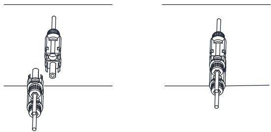
Img5.6 Conexão CC com o inversor
